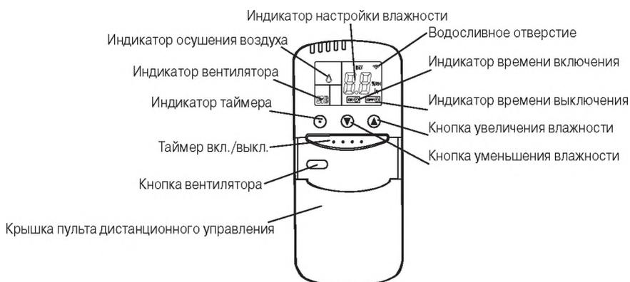
Нажмите любую кнопку пульта дистанционного управления. Загорится индикатор сигнала, означающий, что на устройство подан сигнал. Когда устройство примет сигнал, послышится звуковой сигнал.
