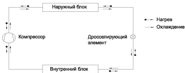
Рисунок 4.2. Схема работы кондиционера
