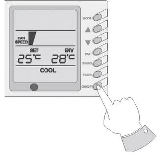
**FAN CONTROL** – кнопка выбора скорости вращения вентилятора – нажатием этой кнопки скорость вращения вентилятора меняется в следующей последовательности:
