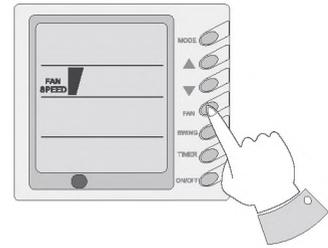
**▲, ▼ (TEMPERATURE SETTING)** – кнопки выбора значения температуры – нажатием этих кнопок соответственно увеличивается или уменьшается значение задаваемой температуры воздуха внутри помещения 1°C.
