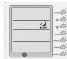
**OPERATING MODE SETTING** – кнопка выбора режима – нажатием кнопки выбирается режим в следующей последовательности: **AUTO** (автоматический) – **COOLING** (охлаждение) – **DEHUMIDIFYING** (осушение) – **FAN** (вентилятор) – **HEATING** (нагрев) – **AUTO** (автоматический).
