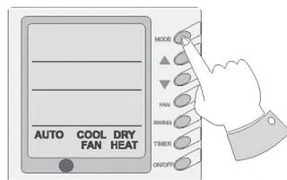
**TIMER SETTING** – кнопка таймер – при нажатии на эту кнопку устанавливается функция включения или выключения кондиционера по таймеру. С помощью кнопок ▲, ▼ устанавливается значение времени таймера.
