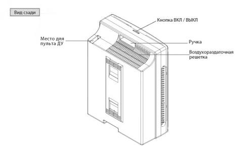
Встроенный в корпус воздухоочистителя вентилятор всасывает воздух и прогоняет его через многоступенчатую систему нескольких фильтров, которые в свою очередь полностью очищают воздух.
